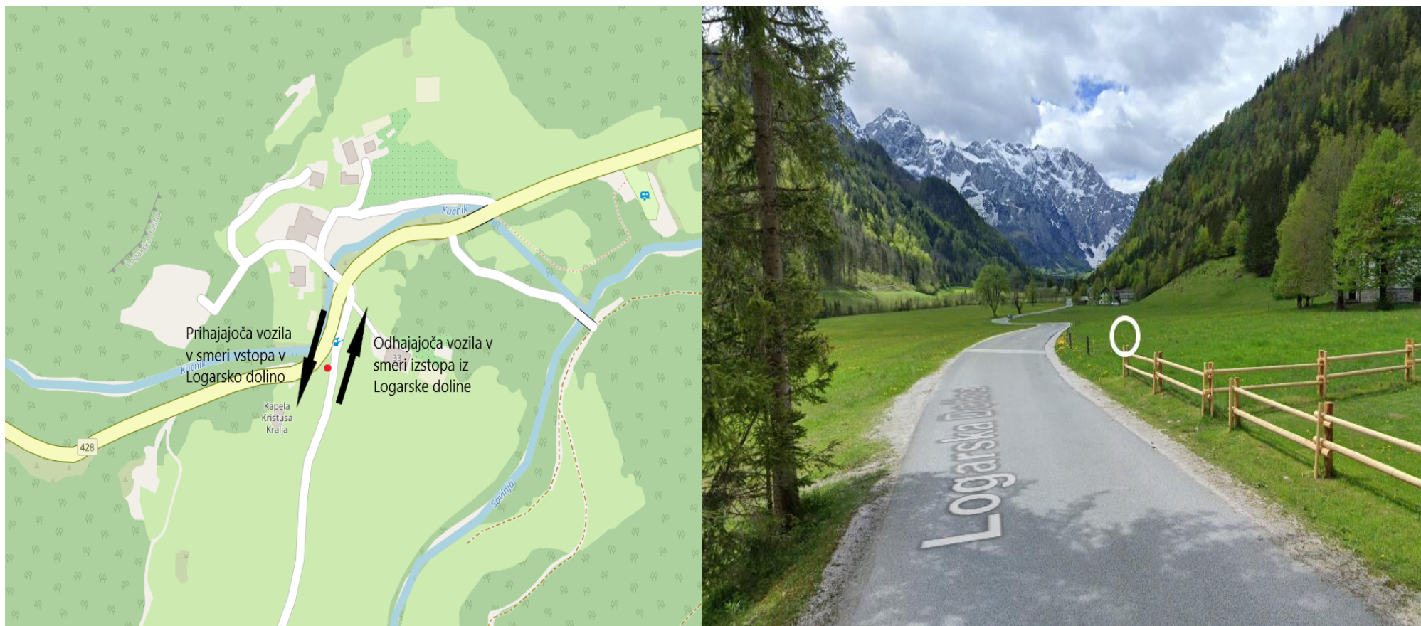
Slika 1: Števec prometa na lokaciji (smer štetja: obe smeri), beli krogec na sliki označuje mesto postavitve števca prometa.
